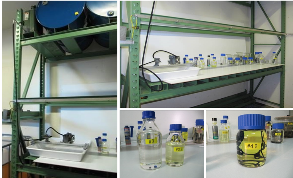
Abbildung 3: Versuchsaufbau für Materialverträglichkeitsuntersuchungen (Fläschchen #3 beinhaltet bio-synthetisches Benzin und Fläschchen #3.2 bzw. #4.2 fossiles Benzin)
