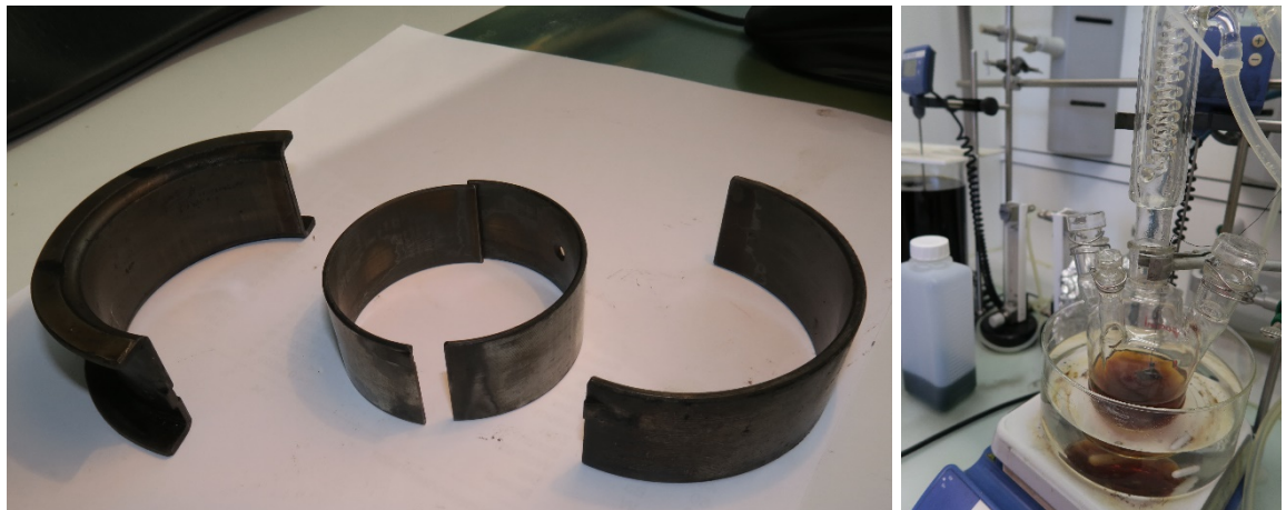
Abbildung 20: Bleihaltige Lagerschalen (links) und Versuchsaufbau (rechts) zur Untersuchung des Angriffs durch ein Gemisch von 10% MTBE und 90% TOPAZ SAE 20W-50 bei 80°C
