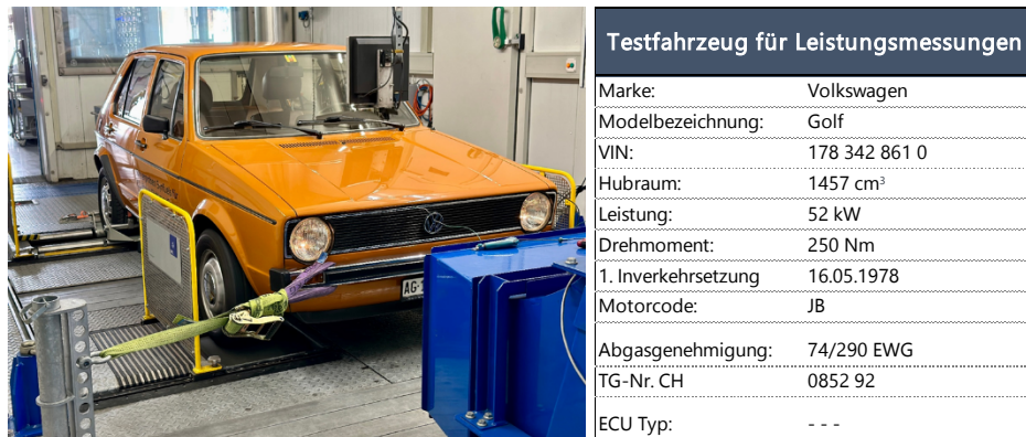
Abbildung 12: Testfahrzeug für Leistungsmessungen
