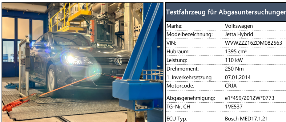
Abbildung 8: Testfahrzeug für Abgasuntersuchungen
