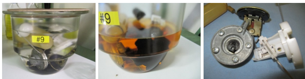
Abbildung 6: Untersuchung Tankgeber, Benzinpumpe und Vergaser im Tauchversuch (links und Mitte) sowie nach Abschluss der Untersuchung
