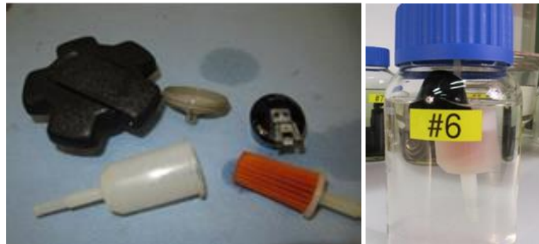
Figura 4: componenti in plastica esaminati per accertare la compatibilità del carburante
