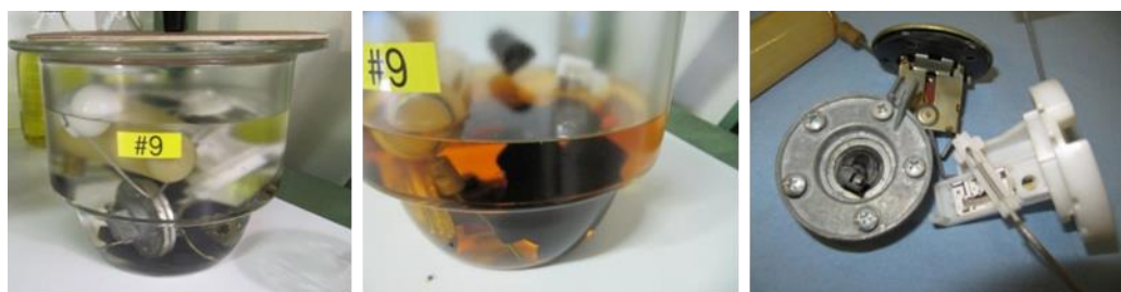
Figura 6: prova indicatore livello serbatoio, pompa della benzina e carburatore nel test con immersione (a sinistra e al centro) e dopo la conclusione della prova
