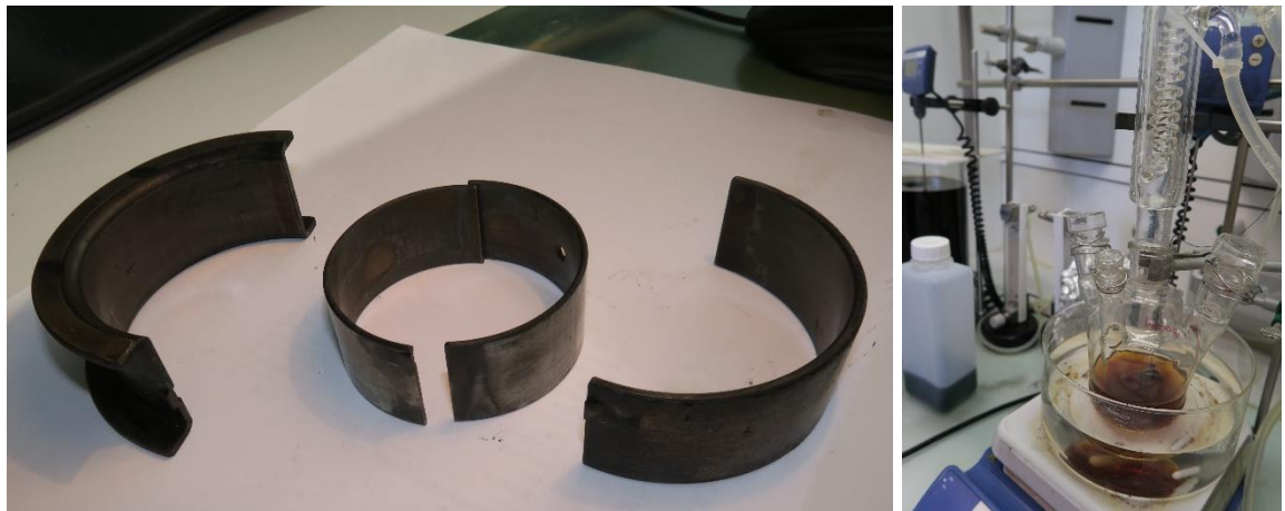
Figura 20: bronzine di cuscinetti contenenti piombo (a sinistra) e configurazione del test (a destra) per indagare l'attacco di una miscela di 10% MTBE e 90% TOPAZ SAE 20W-50 a 80 °C
