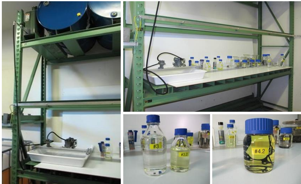
Figura 3: configurazione del test per le prove sulla compatibilità dei materiali (il flacone #3 contiene benzina biosintetica e il flacone #3.2 o #4.2 benzina fossile)
